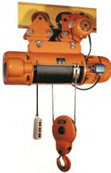
Модель CD1/MD1 Грузоподъемность 0,5-5,0 т. Высота подъема 18-30 м.
